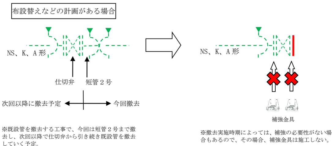
③ 硬質塩化ビニル管、溶接鋼管、ネジ切鋼管のフランジ接合部は、補強金具で固定してしまうと、強い地震が発生した場合、配管に予期しない負荷がかかり破断するなどの影響が懸念されるため、硬質塩化ビニル管、溶接鋼管、ネジ切鋼管側のフランジ接合には施工しない。
